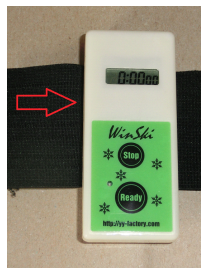
図10 タイマーに内蔵された赤外線センサーの位置
